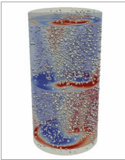
Fig. 1 Configurazione istantanea di una simulazione numerica di un liquido, contenuto in un cilindro, scaldato dal basso (e raffreddato in alto) con il trasporto di bolle al suo interno. Nelle tre sezioni sono raffigurate con colori diversi le zone a diversa velocità verticale (in rosso la massima velocità verso l'alto ed in blu la corrispondente verso il basso).
